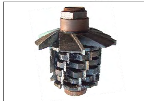
ΞΕΛΟΥΡΙΣΤΙΚΟΣ ΔΙΣΚΟΣ ΦΥΛΛΟΥ MILLING COMPONENT FOR SASH
